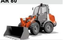
4.650 Kg. 47,5 kW (65 CV) Potencia motriz 0,85 m<sup>3</sup> Capacidad de la cuchara
