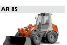
6.700 Kg. Peso en servicio 65 kW (88 CV) Potencia motriz 1,30 m<sup>3</sup> Capacidad de la cuchara
